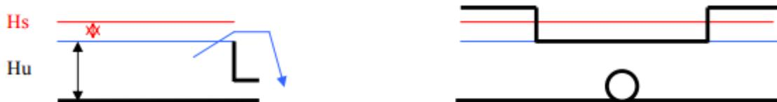
Le dispositif de rétention doit disposer d'une hauteur d'eau supplémentaire  $H_s$  au delà de  $H_u$  pour permettre à la surverse d'évacuer le débit  $Q_{30}$  ( $l/s$ ) =  $0,136 \times S_p$  ( $m^2$ )  $\times C_p$  (%) / 1000.
